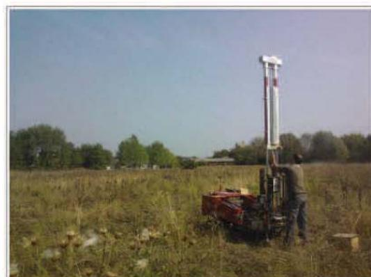
*Foto 2.1 – Mezzo semovente utilizzato per le prove CPT (l'immagine riprende la prova CPT1)*
